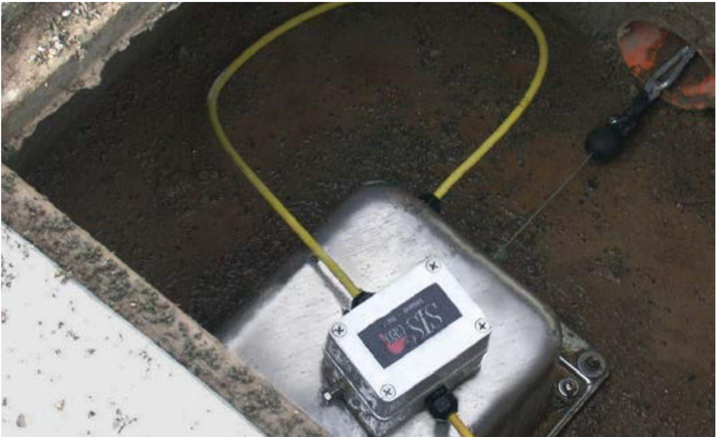
*Fissuromètre à fil installé dans une réservation avec une boîte de jonction avec PCS*
